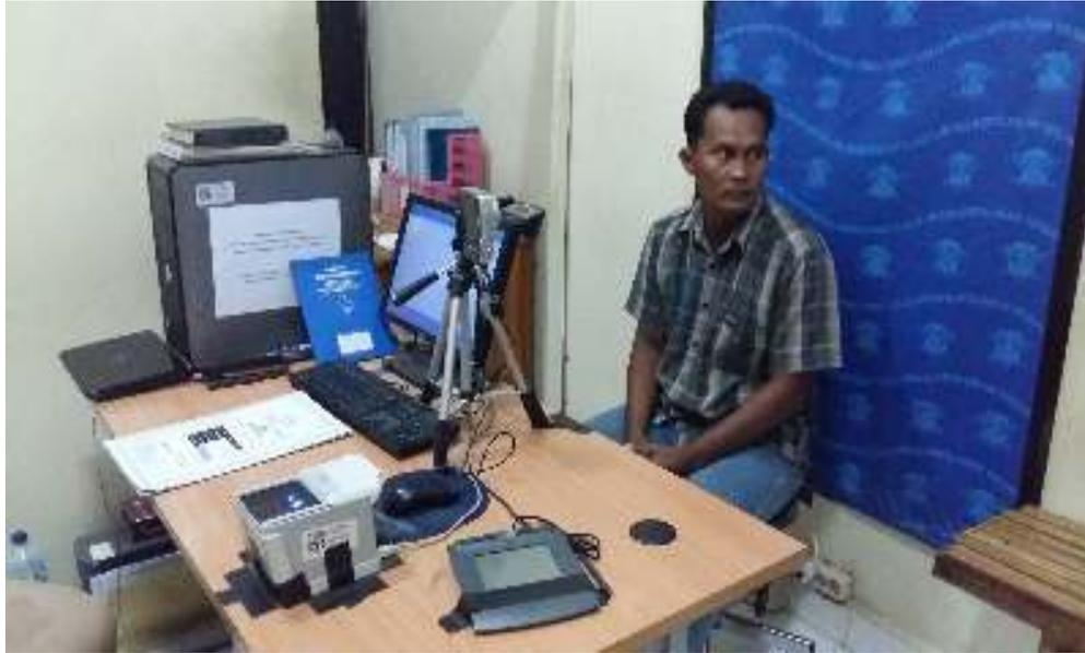
Gambar 17. Perangkat Perekaman Data Pemohon SIM Pada Pelayanan SIM Lokal
