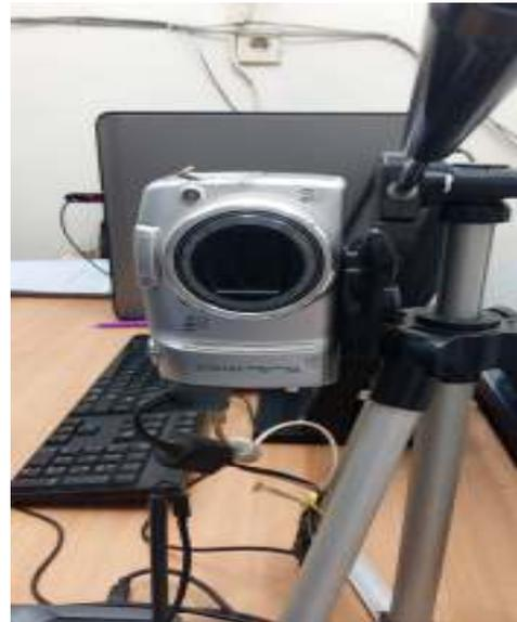
Gambar 41. Perangkat kamera digital Canon Power Shot SX110 IS dan perangkat *Fingerprint Scanner* Hongda S700
