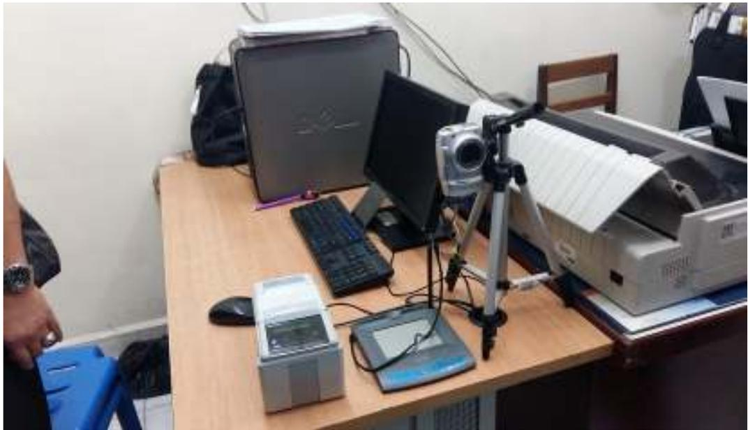
Gambar 45. Perangkat PC client, kamera digital, sidik jari, tanda tangan
