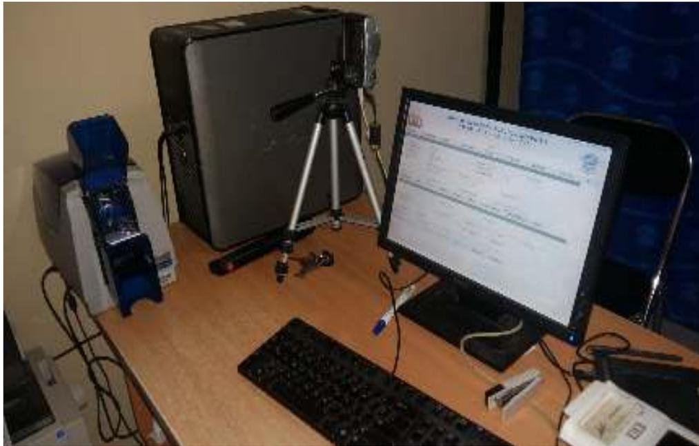
Gambar 20. Perangkat Perekaman Data Pemohon SIM Pada Pelayanan SIM Lokal
