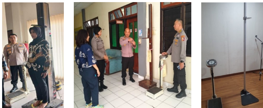
Gambar 13. Alat Ukur Tinggi Badan yang Terbuat dari Model Sensor, Kayu, Aluminium atau Besi.
